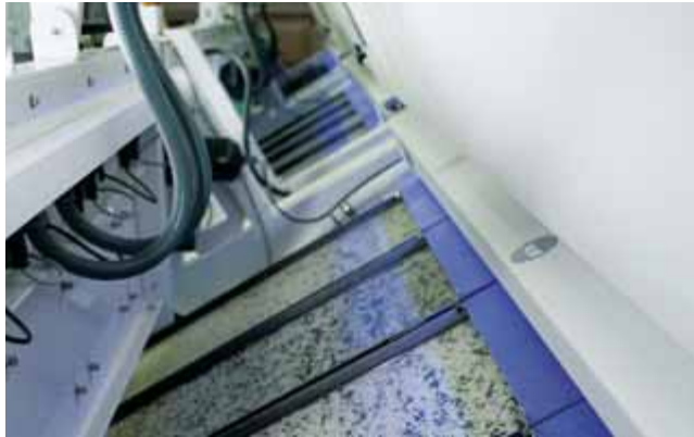
Hightech von Bühler: Sortiermaschine mit hochauflösender Optik für die Weiterverarbeitung von Reis in einer Reismühle nördlich von Bangkok (Ultimate Rice). (Foto: Bühler AG)
